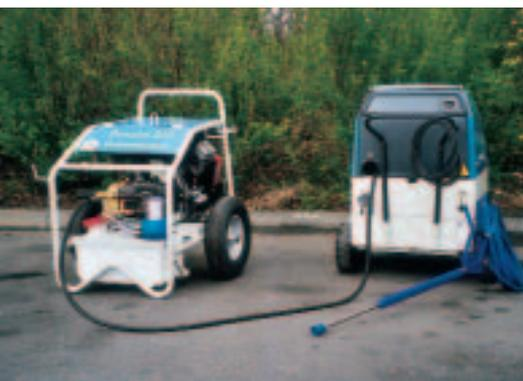
En combinación con el módulo calefactor Dynabox 350, el carro Dynajet 350<sup>mg</sup> se convierte en un auténtico limpiador con agua vaporizada de hasta 130 °C de temperatura.
