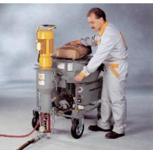
El depósito del material y el tubo mezclador están separados el uno del otro. Abriendo la compuerta, el material seco entra en el tubo mezclador.
