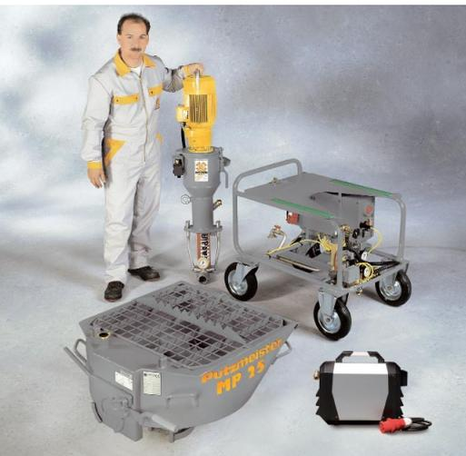
La MP 25<sup>MIXIT</sup> puede ser desmontada en cómodos módulos individuales para su traslado a cualquier lugar.
