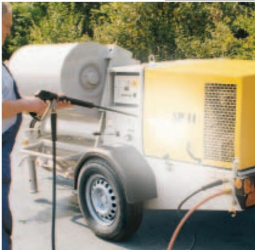
Con el limpiador de alta presión incorporado (DMR) puede limpiar su SP 11 con una presión superior a 100 bar.
