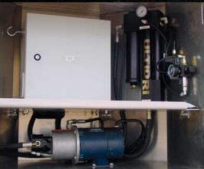
A diferencia de otros sistemas, el deshidratador/filtro de aceite de Putzmeister usa aire seco del chasis y no cartuchos desmontables de alto costo para eliminar los efectos negativos del agua y los contaminantes en el aceite.
