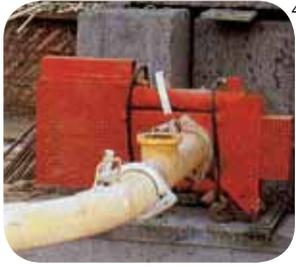
Modelo GVH 2/2 = 2 puertos / 2 posiciones muestra montada horizontalmente.
