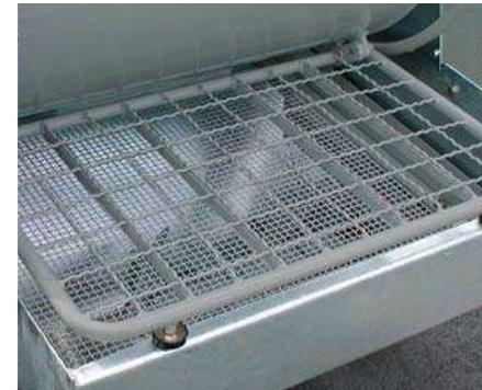
El tamiz tiene un accionamiento vibratorio mecánico y está alojado dentro de la tolva de mortero galvanizada. Puede sacarse para limpiarlo.
