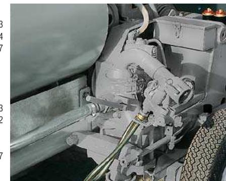
La bomba de doble émbolo (en la figura la KK 139 con hasta 120 l/ min. de rendimiento de bombeo) asegura un trabajo libre de sacudidas en el equipo de proyección.
