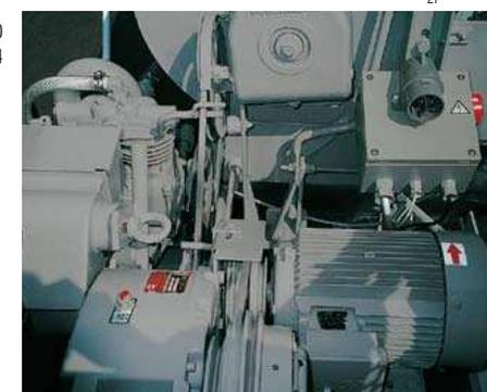
El potente motor eléctrico de 400 V rinde 7,5 kW, la versión „S“ incluso 11 kW.
