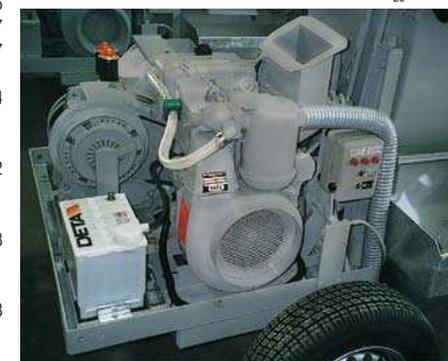
El motor diesel bicilíndrico es sumamente resistente y pobre en mantenimiento. Rinde 12,5 kW.
