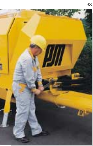
Rápido cambio de alimentación vástago-pistón
