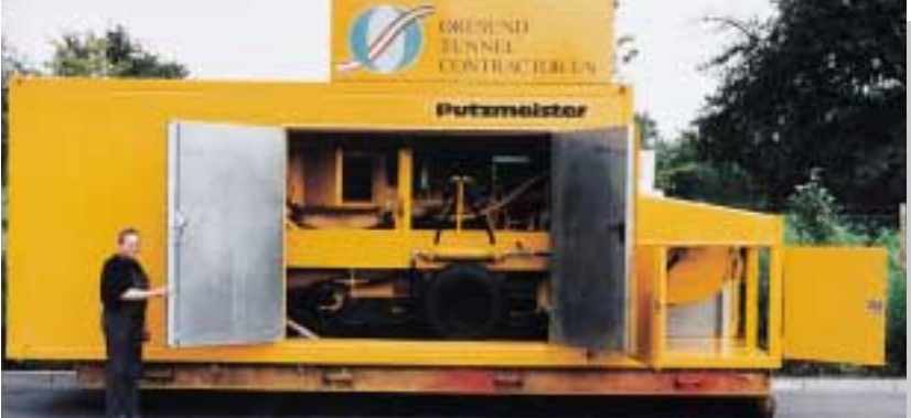
Mínimo ruido de funcionamiento gracias a un container especial estanco
