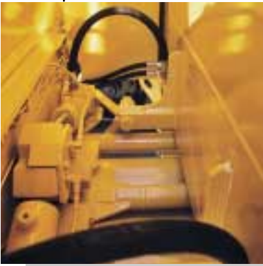
Buen acceso a los cilindros de cambio del tubo oscilante
