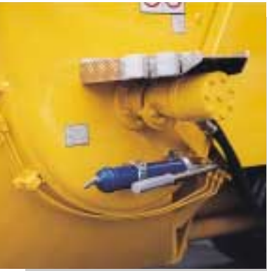
Lubricación central en la tolva
