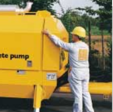
Ideal circulación de aire con la tapa del refrigerador abierta, incluso en condiciones tropicales
