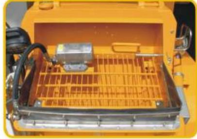
Tolva especialmente diseñada para la gunita. Incluye agitador y vibrador en la parrilla. Capaz de bombear y proyectar fibras de acero/polímeros.
